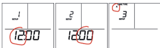
Setup 1 - Uhrzeit eingeben (Stunden) Setup 2 - Uhrzeit eingeben (Minuten) Setup 3 - Tanktyp wählen (A, B oder C)
