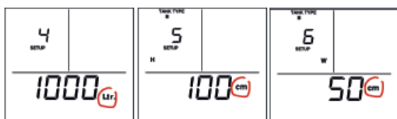
Setup 4 - Volumen des Tanks in Liter Setup 5 - Höhe des Tanks in cm Setup 6 - Breite/Weite des Tanks in cm (Nur Tanktyp B und C)
